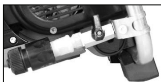
vízellátás zárva (szelepkar keresztben)
